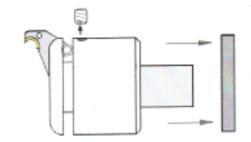
1. Lösen der Ventilschraube und abziehen des Schutzdeckels
