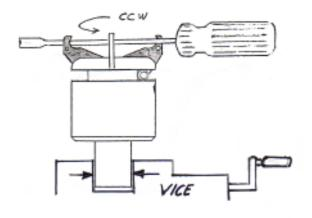
Demontieren der Greifzangen von den Schenkeln. Spannen des Grippex in einen Schraubstock (am Schaft). Mit einem Schraubenzieher in Richtung ccw drehen, das Gehäuse löst sich vom Schaft.
