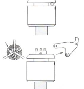
4. Lösen der drei Schrauben (M4x8 mm) am Schaft bis die zylindrischen Passstifte herausgenommen werden können.
