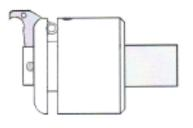
Drehen Sie das Gehäuse ca. 4 mal. Nun werden 3 Bohrungen (Ø4 mm) am Schaft sichtbar.
