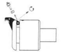
2. Demontieren des Federringes, Entfernen des Stiftes u. der Rollen
