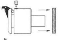
1. Öffnen der Ventilschraube und abziehen des Schutzdeckels
